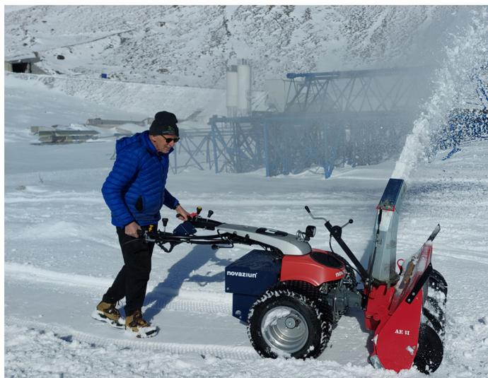
1 Dank dem innovativen Jungunternehmen novaziun AG können handelsübliche Verbrennungsmotoren im Leistungsbereich von 5-15 kW kostengünstig und breitflächig durch E-Motoren ersetzt werden.
