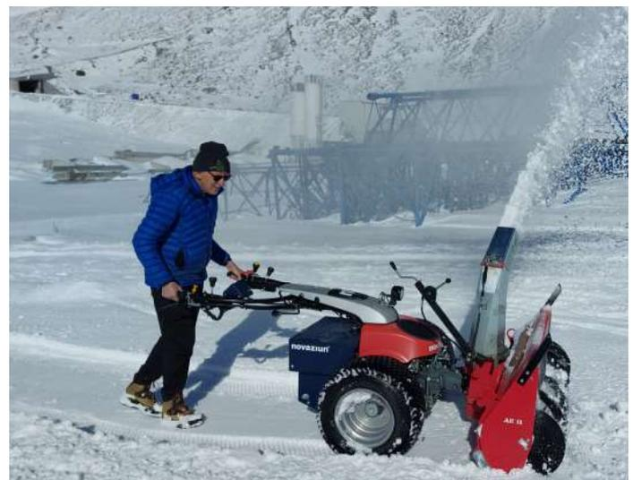
1 Dank dem innovativen Jungunternehmen novaziun AG können handelsübliche Verbrennungsmotoren im Leistungsbereich von 5-15 kW kostengünstig und breitflächig durch E-Motoren ersetzt werden.
