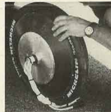
Links: «Radnabenmotor», ein Spitzenprodukt aus Biel, erreicht 150 km/h; rechts: WSC-Zieleinfahrt in Adelaide/Australien 1996
